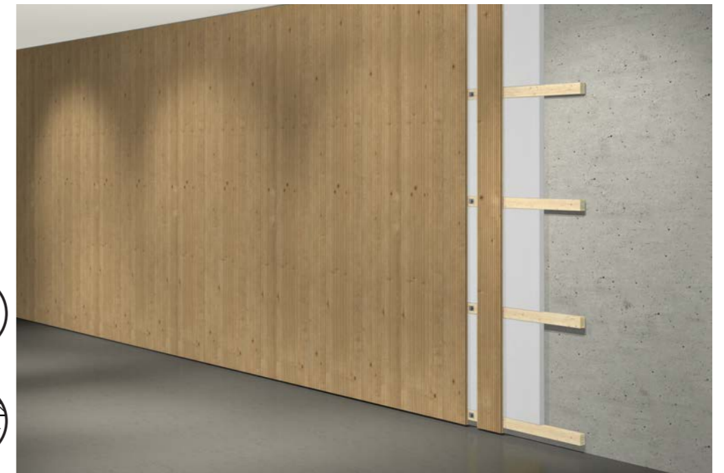
vertikale Montage ohne Versatz mit umlaufender Schattenfuge
