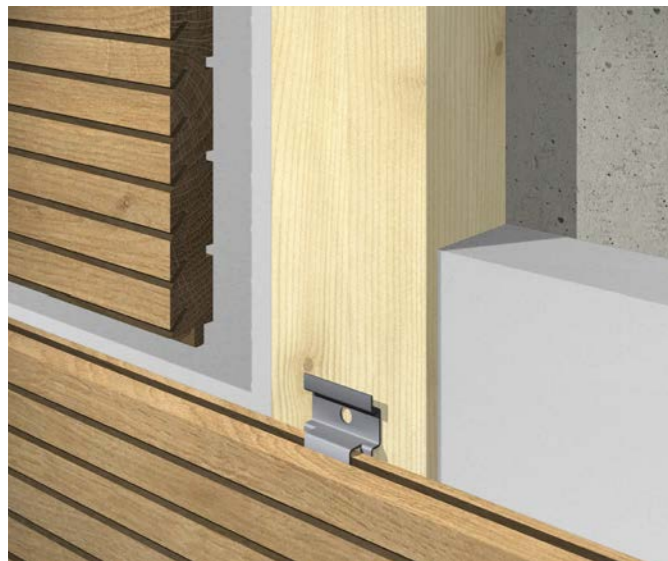
Detailansicht: horizontale Montage mit Montageclip
