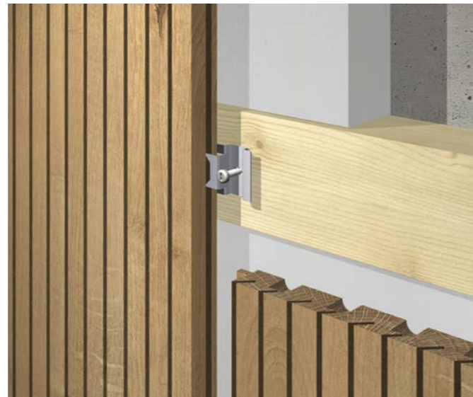
Detailansicht: vertikale Montage mit Montageclip
